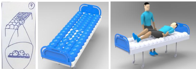
Figura D.1 – Ilustração da ideia de produto 7 - Colchão inflável com módulos independentes
