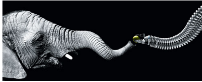
Figura 3.2 – Exemplos de projetos bio-inspirados realizados pela Festo ® – Atuador inspirado na tromba de um elefante.
